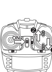
③送信機の電源を入れスロットルスティックをフルハイ(100%)位置に上げ(図②)、すぐに0(ゼロ)位置(図③)に戻します。
