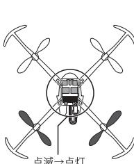
④機体のLEDが点滅から点灯に変わり、操作できる状態になります。
