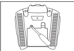
カバーを閉じ、ネジを締めて\*固定します。
