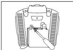
裏ぶたのネジをドライバーで外し、カバーを外します。
