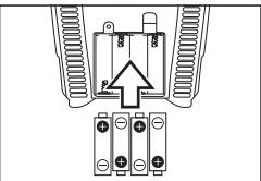
単三乾電池を4本、図のように正しい向きにセットします。
