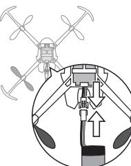
②機体にLiPoバッテリーを接続し、バッテリーをバッテリーホルダーに収納します。ジャイロが正しく機能する様、機体を水平な場所に置いてください。
