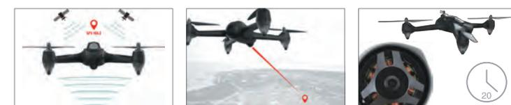
GPSと気圧センサーによる自動ホバリング制御を実現。
