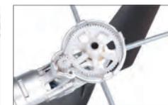
大径プロペラを力強く駆動、フライトの質を劇的に向上させるギヤダウン・パワーユニット。
