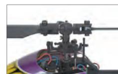
本格的な大型3Dヘリと同様の基本構造を持つ、可変ピッチ・スタビリス構造。
