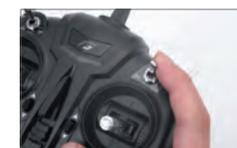
スイッチひとつで、3軸・6軸ジャイロを切替え可能。
