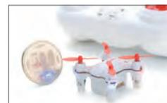
全長27mm、軸間22mm、総重量はわずか7.8gの世界最小クラスドローン。
