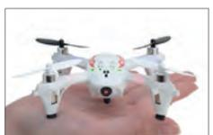
全長95mm・総重量55g! FPV機最小級のコンパクト設計。
