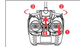
2.送信機の電源が切れている状態で、**スロットルスティックを最スロー位置**にします。
