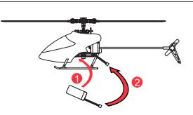
1.機体に① LiPoバッテリーをスキッドに差し込み、しっかりと装着されていることを確認してから、② LiPoバッテリーと機体側コネクタを**極性に注意して接続**します。
