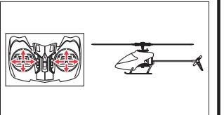
3.機体が操作可能になつたら、いきなりフライトせず必ず送信機の各スティックが正しく動作するかを確認してください。また、機体各部に異常がないか確認し、異常があるときは**修理/バーツ交換**してからフライトさせてください。
